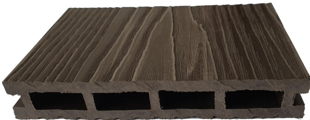
Рис. 1 фото образца ДТ №1 29.12/21 кор. Террасная доска из ДПК 145 x 24, цвет коричневый
