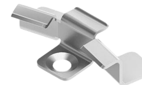
Кляймер промежуточный UnoDeck материал нержавеющей сталь высота лапки 8 мм зазор 3-5 мм
